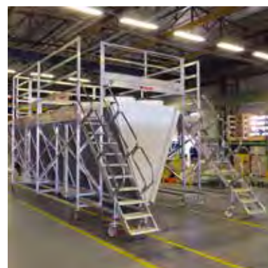
EM1109 Pasarela / Passadiço
