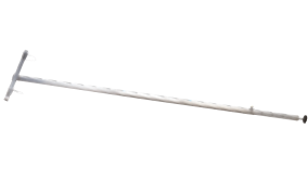
SopORTE intermedio regulable en altura. Cerrado 2,23m. Extendido 3,73 m. Peso 5,30 kg. Suporte intermédio regulável em altura. Fechada 2,23 m. Extensão de 3,73 m. Peso 5,30 kg.
